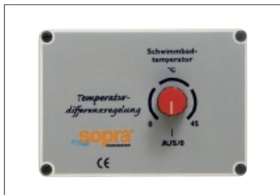
Der sopra-Temperaturregler vergleicht die am Drehregler eingestellte Sollwassertemperatur mit der aktuellen Wassertemperatur und steuert ggf. eine Heizungspumpe an.
